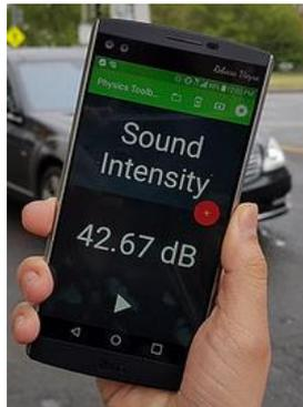
Avec trois smartphones , on peut montrer que si l'intensité sonore double, le niveau d'intensité sonore augmente d'environ 3 dB.
