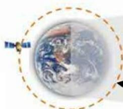
A chaque révolution, le satellite passe dans l'ombre de la Terre, son alimentation est assurée par ses batteries d'accumulateurs.
